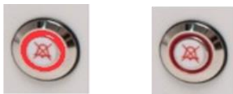
Abbildung 15.1 Alarmtaste zur Anzeige der Alarmbedingung
